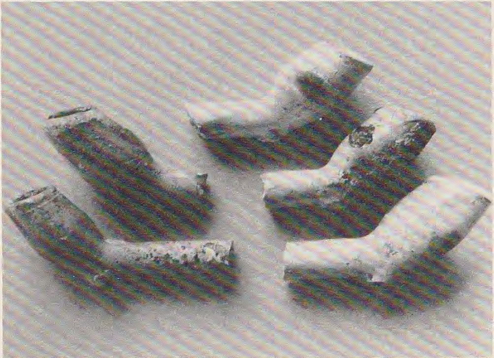
Afb. 1 Enkele gesinterde misbaksels
